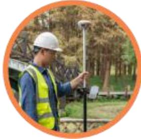
CHCNAV iStar2.0, Hybrid GNSS Engine, 1408-Kanal und, integrierter SoC, 96% zuverlässigere Fixrate, 20% verbesserte Datenqualität
