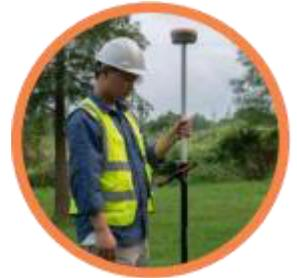
200 Hz AUTO-IMU macht manuelle Initialisierung überflüssig, Automatischer Stabneigungs-ausgleich, 3 cm Genauigkeit bei einem Neigungswinkel von 60°, bis zu 30% Zeitersparnis
