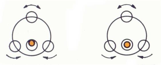
**Das Instrument ist messbereit, wenn sich die Libellenblase innerhalb des eingezätzten Kreises befindet.**
