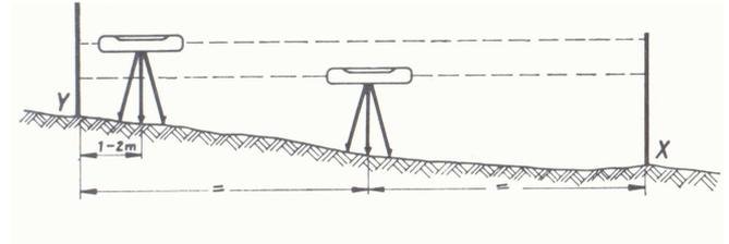
1. Vor Beginn dieser Prüfung wird das Instrument gemäß Abb. (evtl. unter Benutzung des Distanzmessers siehe Abschnitt E) genau in der Mitte zwischen zwei 60 m voneinander entfernten Nivellierlatten aufgestellt (sichere Aufstellungspunkte wählen und die Latte genau senkrecht halten).
