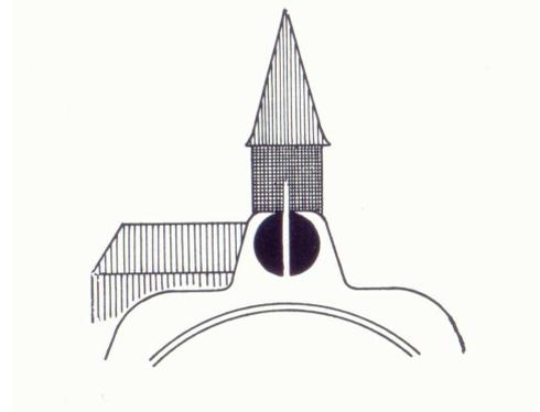
Vor der Ablesung, zumindest bei jeder neuen Aufstellung, ist die Funktion des Kompensators zu prüfen. Zu diesem Zweck betätigen Sie Kontrollknopf [9] unterhalb des Nivelliers. Nach einem kurzen Ausschlagen muss dasselbe Bild in seine ursprüngliche Einstellung zurückpendeln.
