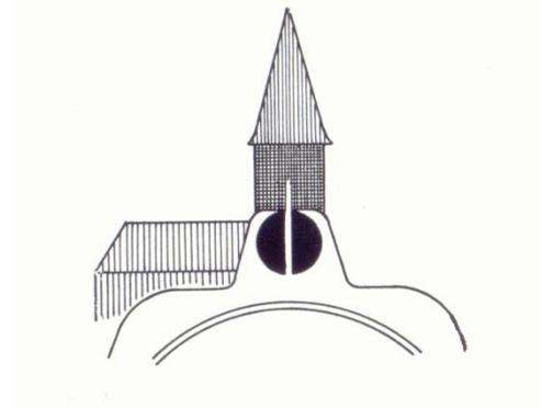
Contrôler le bon fonctionnement du compensateur avant la lecture, au moins à chaque nouvelle mise en place. A cette fin, appuyer sur le bouton de contrôle [9] sous le niveau. Après un bref arrêt des oscillations, la même image doit à nouveau osciller dans sa position de départ.
