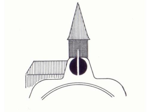
Vor der Ablesung, zumindest bei jeder neuen Aufstellung, ist die Funktion des Kompensators zu prüfen. Zu diesem Zweck betätigen Sie Kontrollknopf [9] unterhalb des Nivelliers. Nach einem kurzen Ausschwingen muss dasselbe Bild in seine ursprüngliche Einstellung zurückpendeln.
