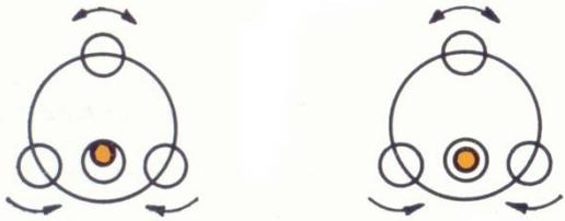
**L'instrument est prêt à être utilisé lorsque la bulle de la nivelle se trouve à l'intérieur du cercle gravé.**
