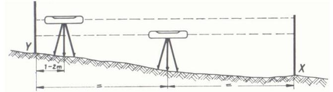
1. Vor Beginn dieser Prüfung wird das Instrument gemäß Abb. (evtl. unter Benutzung des Distanzmessers siehe Abschnitt E) genau in der Mitte zwischen zwei 60 m voneinander entfernten Nivellierlatten aufgestellt (sichere Aufstellungspunkte wählen und die Latte genau senkrecht halten).
