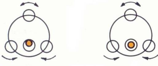
**Das Instrument ist messbereit, wenn sich die Libellenblase innerhalb des eingezätzten Kreises befindet.**
