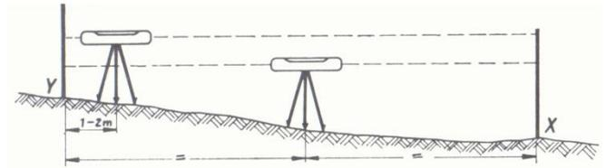
1. Avant le début de ce contrôle, placer l'instrument précisément au centre, entre deux mires séparées de 60 m conformément à l'illustration (éventuellement en réalisant une mesure de distance, cf. point E). Choisir un emplacement sûr pour la mise en place et maintenir la mire parfaitement à l'horizontale.
