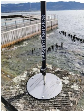
Abbildung 2 Positionierung des Rovers über dem Referenzpunkt
