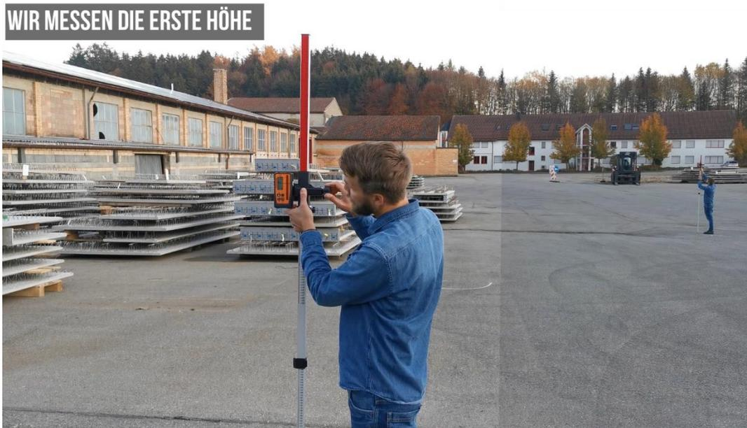
Abbildung 7 Messung der Höhendifferenz mit einem Rotationslaser
