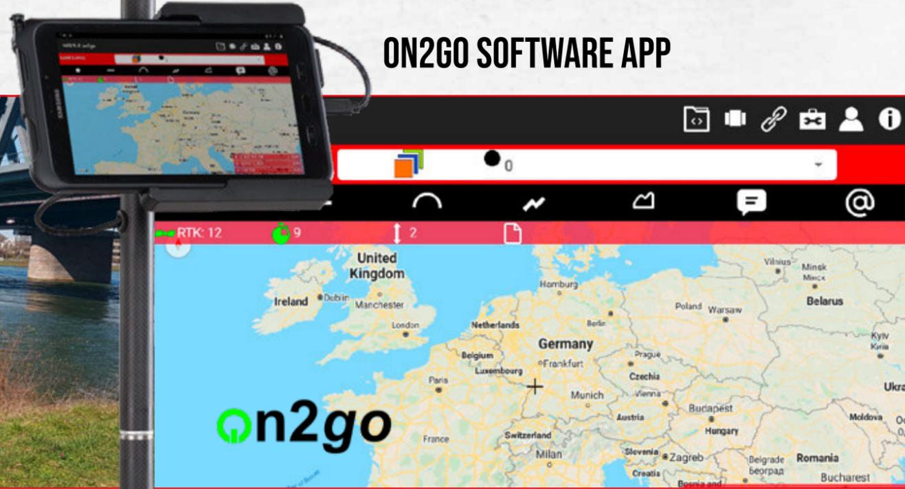
Die On2go App für das GNPS System der Gottlieb Nestle GmbH ist eine Anwendung für mobile Satellitenpositionierung in Echtzeit (RTK).
