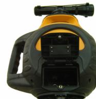
Introduire le bloc à piles dans l'appareil
