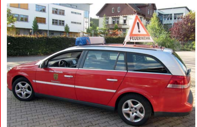
Magnetfuß zur Befestigung auf Fahrzeug
